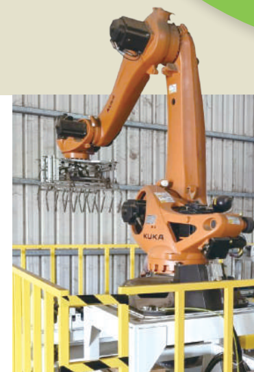
義竹場智慧機械手臂 導入KUKA機械手臂進行自動堆疊，落實工業4.0智慧製造
